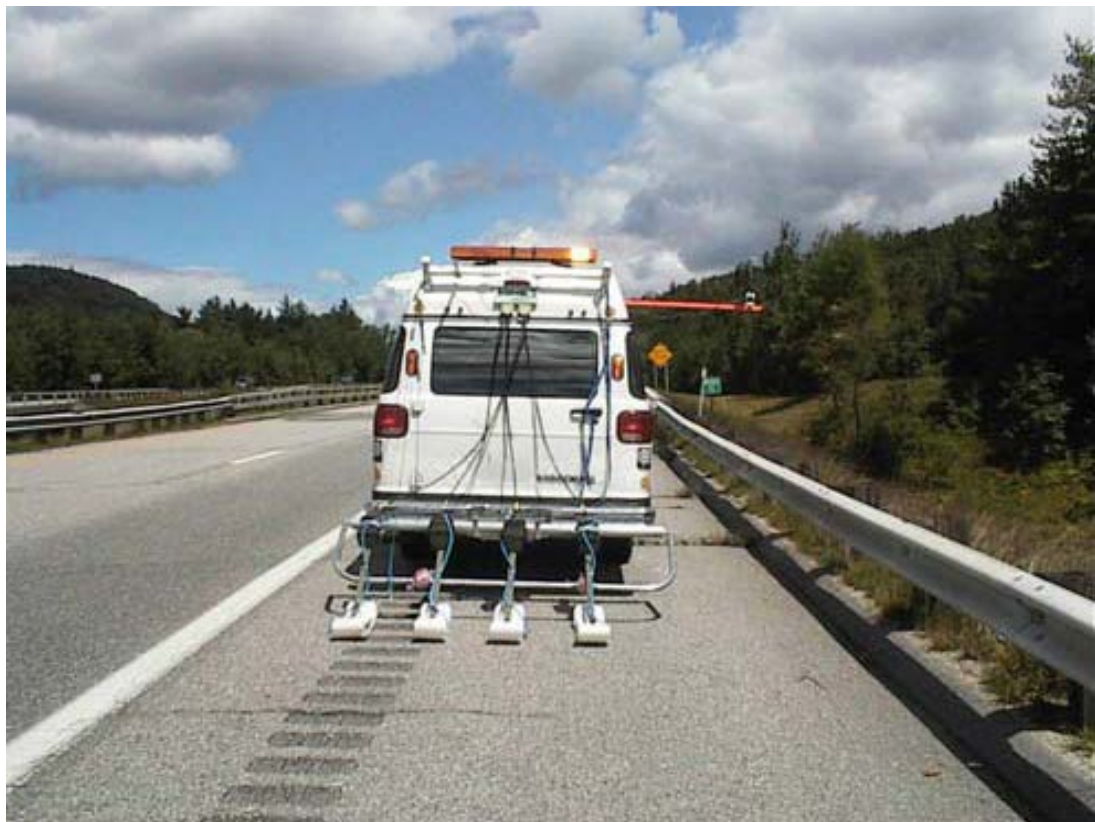
شکل (۳-۲۹) خودروی برداشت GPR در حال عملیات در جاده برای شناسایی عمقهای کم
