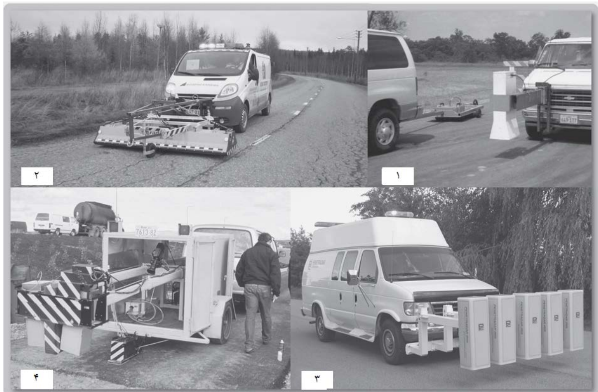
شکل (۳-۲۸) سیستم های مختلف GPR و پیکربندی های مختلف آنتن های مورد استفاده در پیمایش های راه سازی. عکس ۱، یک آنتن ۱۰۰ مگا هرتز دوتایی - زمینی GSSI و یک آنتن رادار اگیگا هرتز می‌باشد که بوسیله موسسه حمل و نقل تگزاس (TTI) مورد استفاده قرار گرفته است. عکس ۲ سیستم رادار چند کاناله برای مطالعه رادار سه بعدی در نروژ می‌باشد، عکس ۳ یک سیستم آنتن شیپوری چند کاناله دوتایی - هوایی ساخت شرکت Penetradar را نشان می‌دهد، عکس ۴ یک سیستم راداری راه کانادایی را نشان می‌دهد که یک سیستم آنتن شیپوری و یک آرایه آنتن دوتایی - زمینی چند کاناله می‌باشد.
