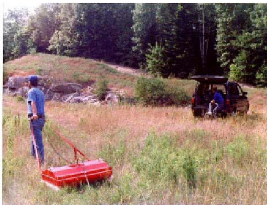
شکل (۳-۳) تیم برداشت و تجهیزات برداشت با آنتن‌های زمینی برای برداشت عمق‌های بیشتر
