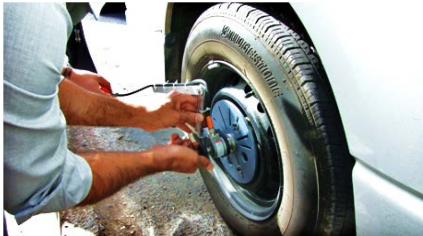
شکل (۴-۲۱) نمایی از نصب مسافت سنج و دیسک مربوط به آن
