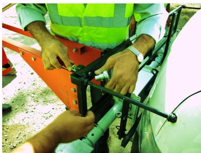
شکل (۱۹-۴) نحوه اتصال آنتن به سیر تعبیه شده
