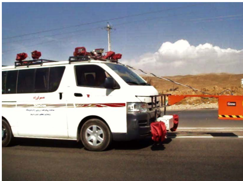
شکل (۴-۱۵) دوربین‌های نصب شده روی خودرو جهت عکسبرداری از محورهای مورد نظر
